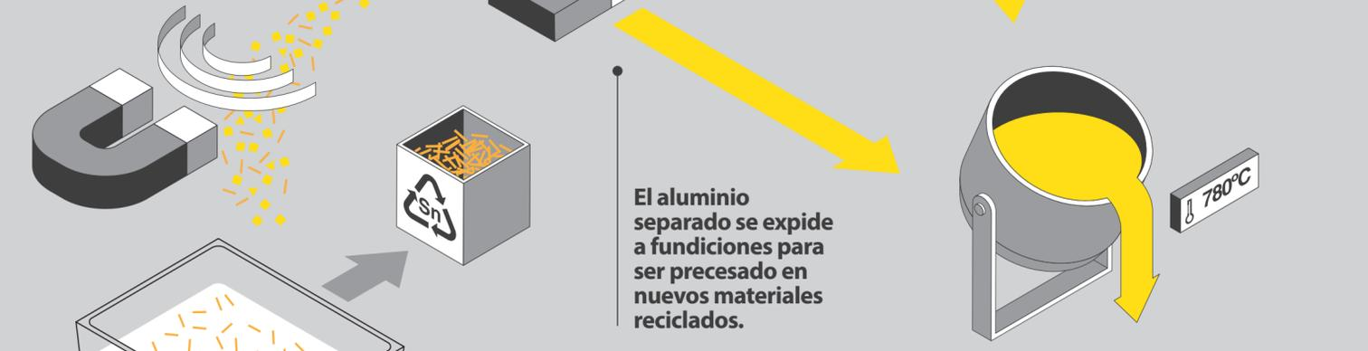
El aluminio separado se expide a fundiciones para ser procesado en nuevos materiales reciclados.
