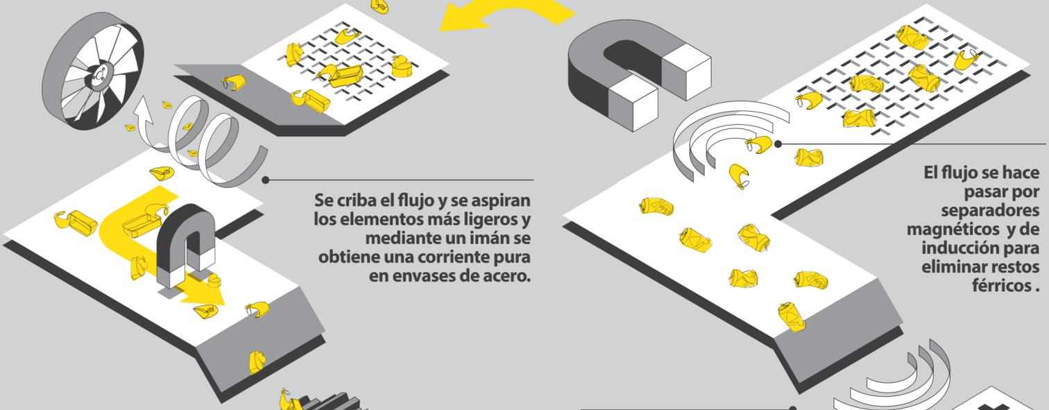
Se criba el flujo y se aspiran los elementos más ligeros y mediante un imán se obtiene una corriente de acero.
